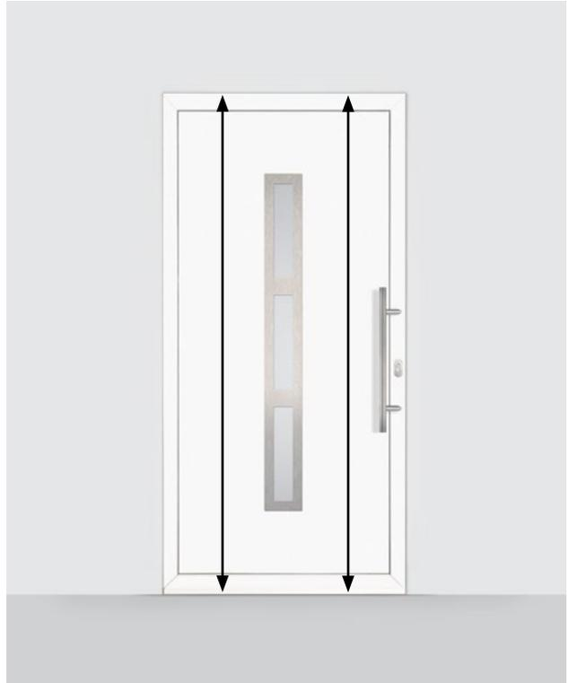
1. Messen Sie im linken Drittel die Höhe der Haustür von der Oberkante der Tür bis zur Oberkante des fertigen Fussbodens und notieren Sie den Wert.
